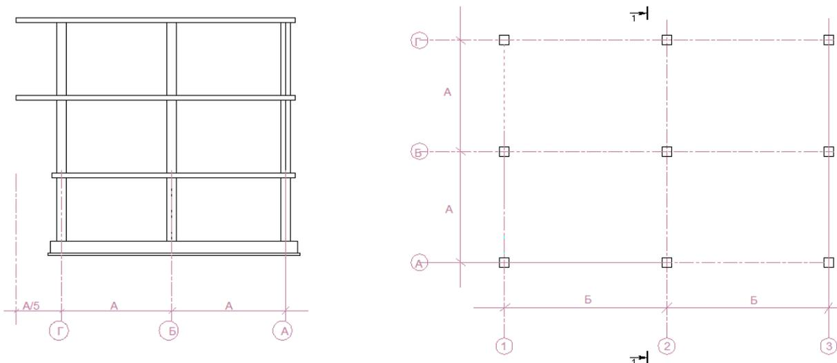
Фундаментную плиту принять толщиной 500 мм, бетон конструкций – класса В25. Нагрузки и данные, не описанные в таблице задания принять по Примеру 4.
